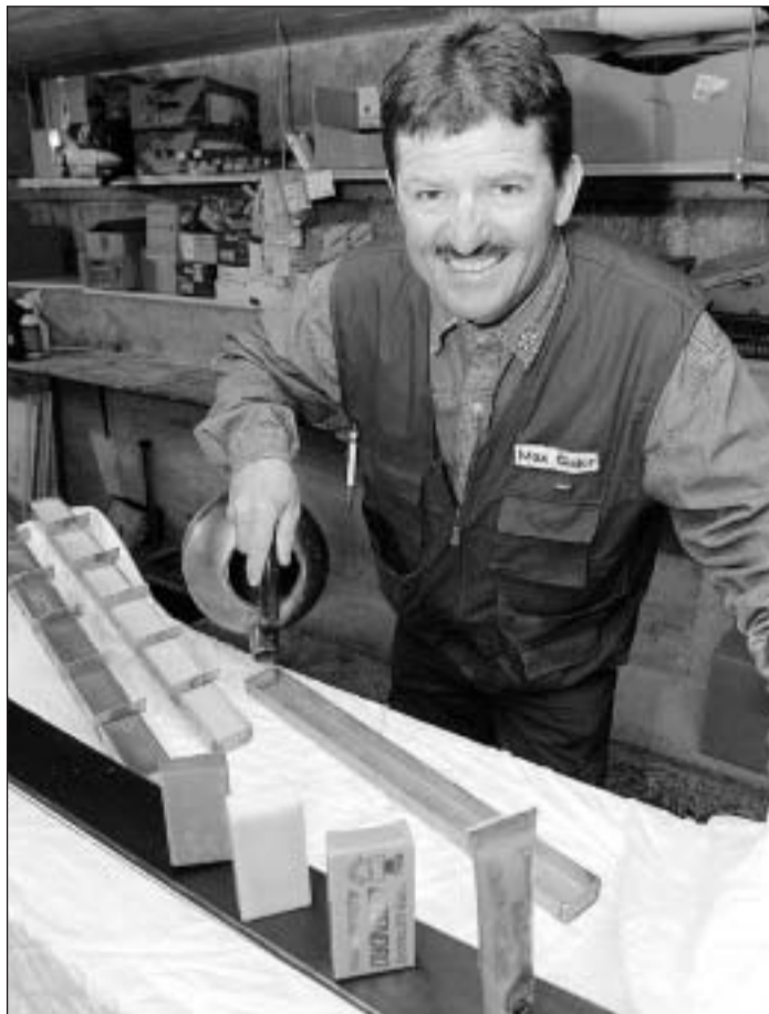
Kleinserie aus der Werkstatt: Max Gisler gießt die heisse Lucendro-Wachsmischung aus dem alten Teekessel in die Form. Bild Peter de Jong
